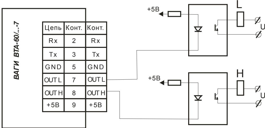
Рис. 2. Приклад підключення пристроїв дозатора.
