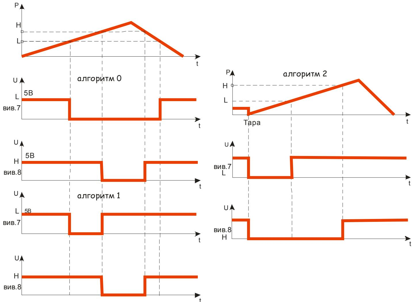
Рис. 3. Графіки спрацювання вихідних сигналів в залежності від типу алгоритма
