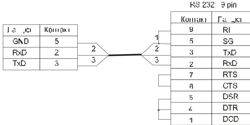
Рис. 4. Схема паяння кабелю для з'єднання ваг із комп'ютером.
